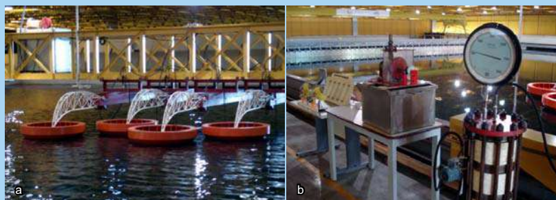
Figura 15.36 Usina em escala reduzida para teste e instrumentos de medição do LabOceano/COPPE/UFRJ. [Fonte: COPPE, UFRJ].
