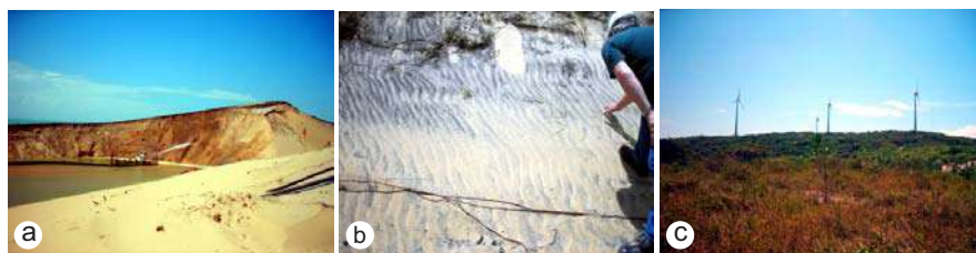
Figura 15.14 Aspectos da mineração de metais pesados leves em Mataraca (PB): (a) jatos de água e dragagem por sucção; (b) manchas de minerais pesados, e (c) reabilitação da área minerada. A concentração primária é feita através de água em espirais. Posteriormente, são utilizados métodos eletromagnéticos. [Foto: CALLIARI, Lauro].
